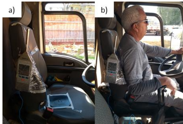
Figura 24 – Aquisição de exposição a VCI e ao ruído: (a) aparelhos fixados no assento e poltrona de encosto. (b) motorista em sua diária normal de trabalho.
